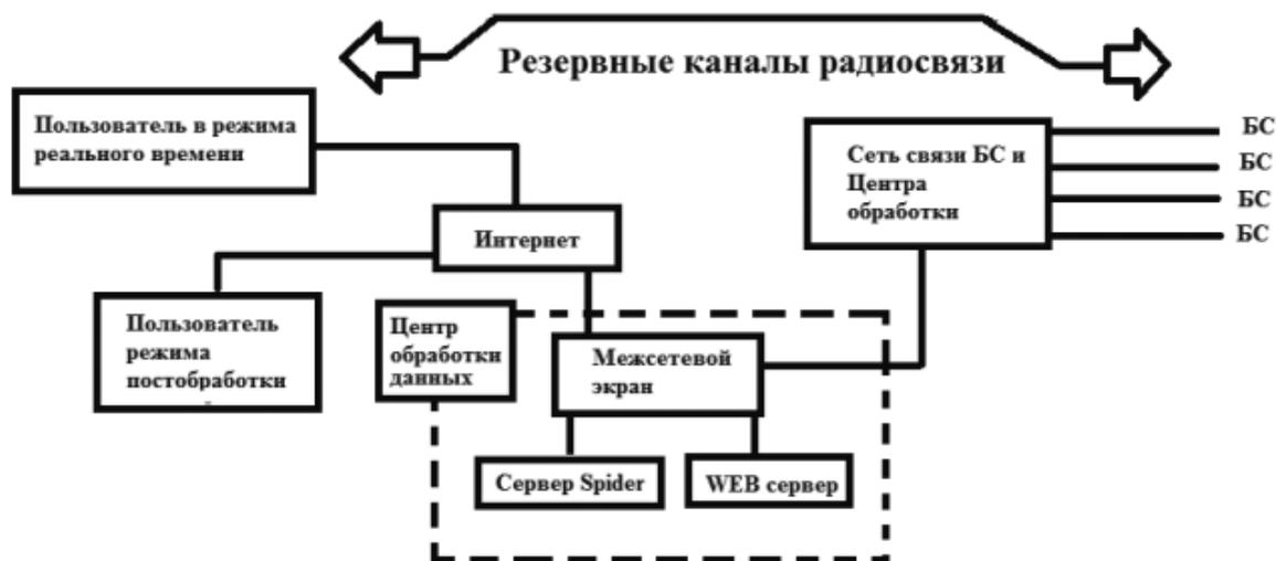
Рис. 11. Общий принцип работы базовых станций
