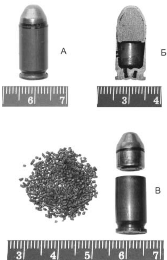
Фото 1. 9-мм патрон правоохранительных органов (ППО): А – общий вид, Б – продольный механический разрез, В – компоненты.
