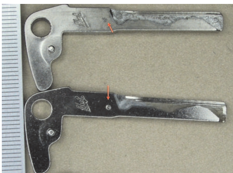
Фото 12. Вид стержней ключей с пятигранным отпечатком. Стрелками указаны пятигранные отпечатки.
