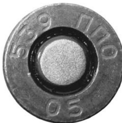
Фото 2. Маркировочные обозначения, нанесенные на дно патрона ППО.
